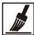
Наносить с помощью жесткой кисти для нанесения клеевых уплотнительных масс или с помощью шпателя.
